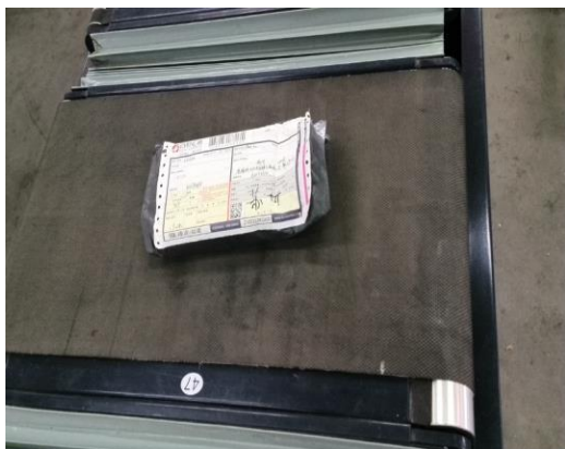
放置在下车皮带机中间或者稍微靠前位置 (正确)
